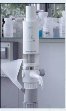
Adaptateur avec tubulure de remplissage RS 12/21 pour entonnoir
