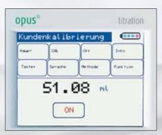
Avec le menu de réglage "Quick-Cal" le calibrage individuel est confortable et sûr.
