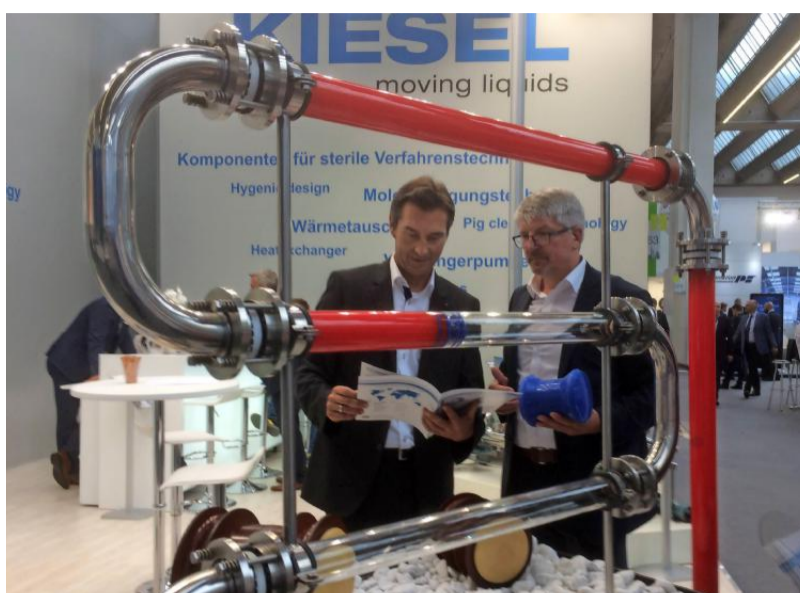
Ein Molch der Heilbronner Traditionsfirma Kiesel schiebt die rote Farbe aus der Rohrleitung. Bis morgen läuft die Fachmesse Achema noch. Foto: Manfred Stockburger
